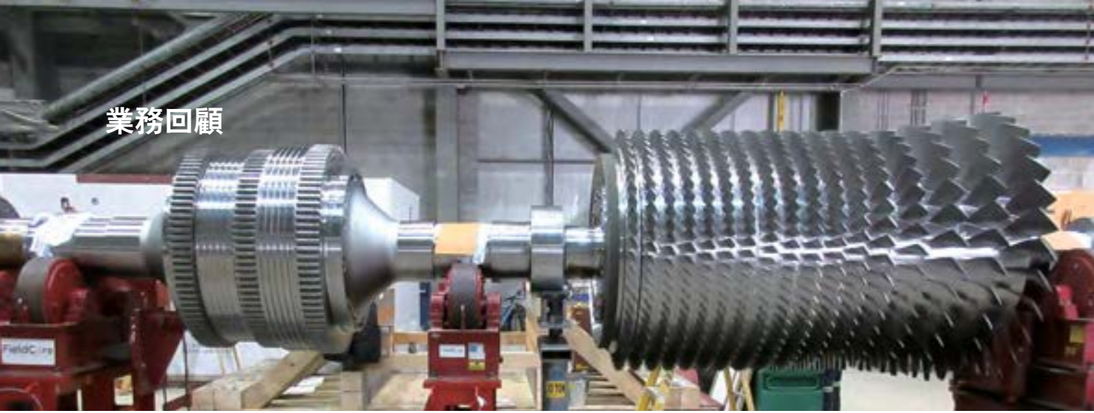
Canadian Power 的 Meridian 熱電廠完成更換其中一台燃氣渦輪機回轉軸的工程。
