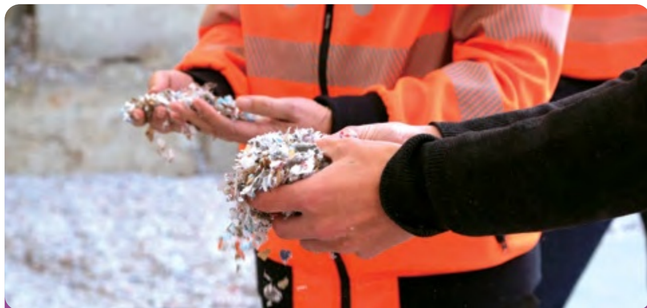
Enviro NZ 於旗下 Pōkeno 資源循環再用設施，將無法回收塑料及其他殘餘物料轉化為加工工程燃料 (Process Engineered Fuel)。此乃新西蘭首個同類項目。
