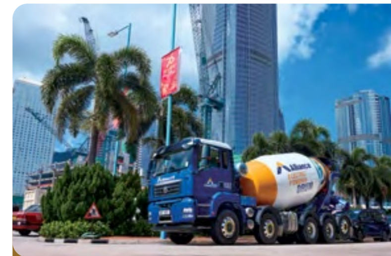
友盟引入安裝於柴油貨車底盤之電池驅動混凝土攪拌筒，相比傳統的柴油攪拌筒，燃料用量可減少達百分之三十。
